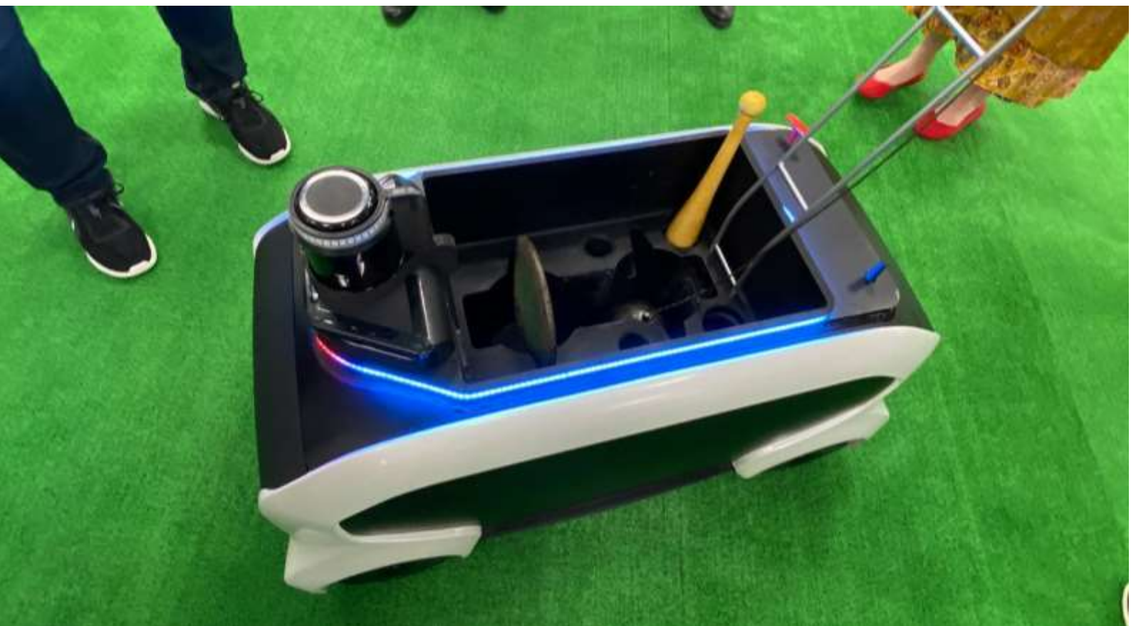
FSR (Field support robot), robot za pomoč na terenu, bo opremljen z avtonomnimi funkcijami, ki bodo olajšale delo podpornemu osebju na različnih tekmah, ki vključujejo metanje in kjer je potrebno te predmete čim prej pridobiti nazaj. Izračunal bo najboljšo pot, z najmanj ovirami in vodil osebje do predmeta.
